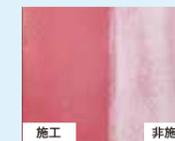
非施工面は紫外線劣化して退色しているのに対し、ピュアコート施工面は変化が見られない。
